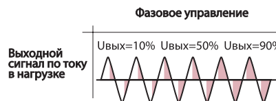
Диаграмма срабатывания ТТР KIPPRIBOR с фазовым управлением.
